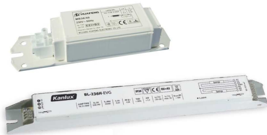
Obrázok 3 Základné druhy predradníkov pre žiarivky s označením indexu energetickej triedy EEI, a) klasický predradník (EEI: B až D) [7], b) elektronický predradník (EEI: A1 až A3) [4]
